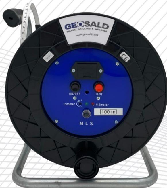
Strumento portatile per la misura del livello della falda e la profondità del foro di pozzi e piezometri, montato su rullo avvolgicavo nel cui interno è alloggiata una scheda elettronica per il condizionamento del segnale sia acustico che luminoso.
